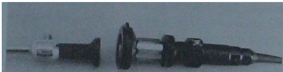
Lắp trực tiếp ống kính nội soi với đầu camera
